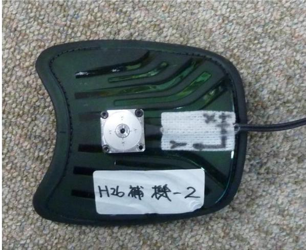
写真3 小型3軸力覚センサの装着状況
