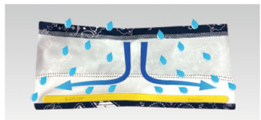
SWEAT BLOCK TECHNOLOGY 「スウェットブロック・テクノロジー」という特許技術により、内側の黄色いゴム製のシールドが顔に落ちてくる汗を左右に誘導し、目へ流れることを防ぎます。
